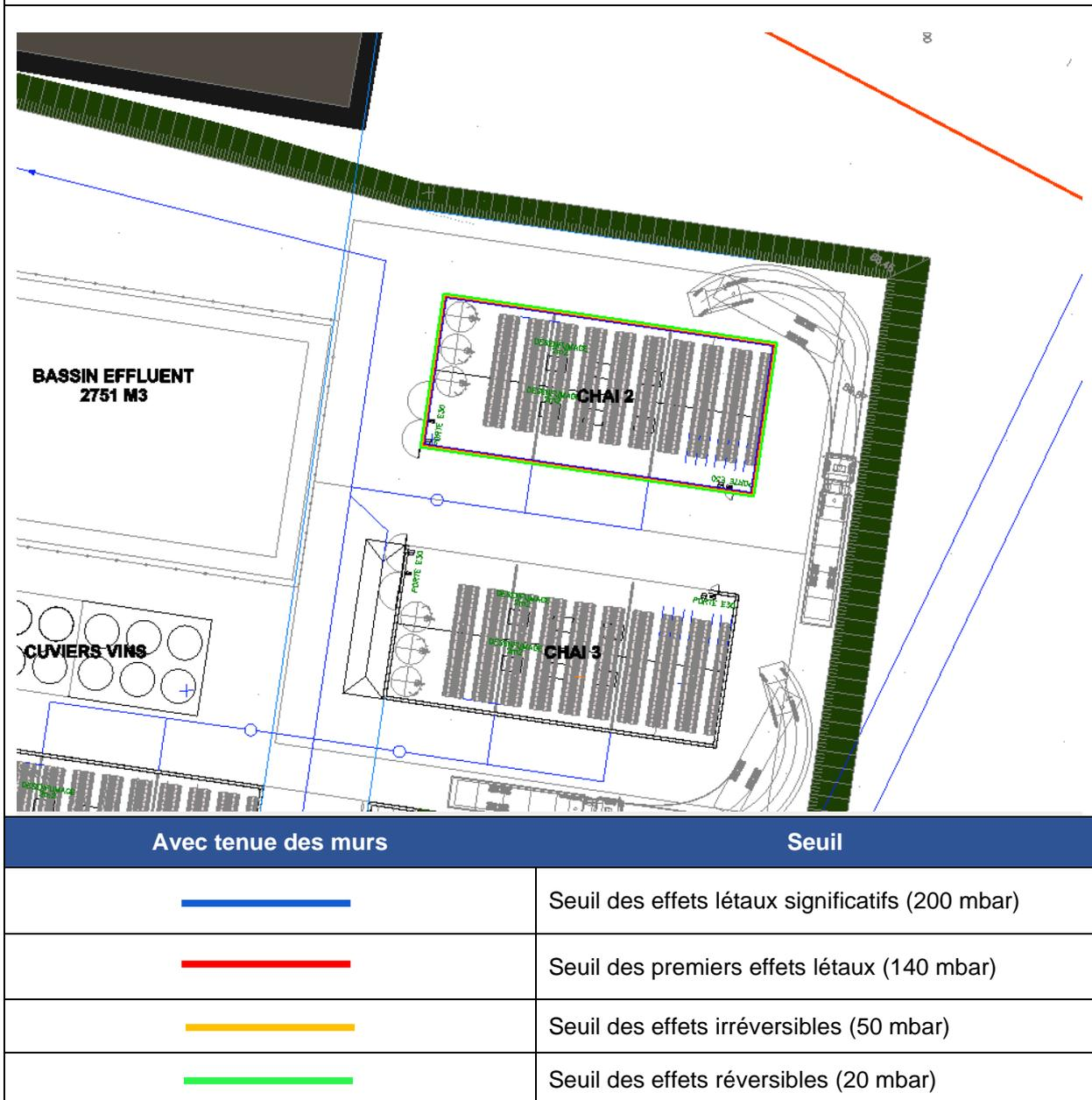
En considérant la présence des murs et l'évacuation de la surpression par la toiture du chai, il n'y a pas d'effets à attendre à l'extérieur du chai (hormis en façade des ouvertures).
