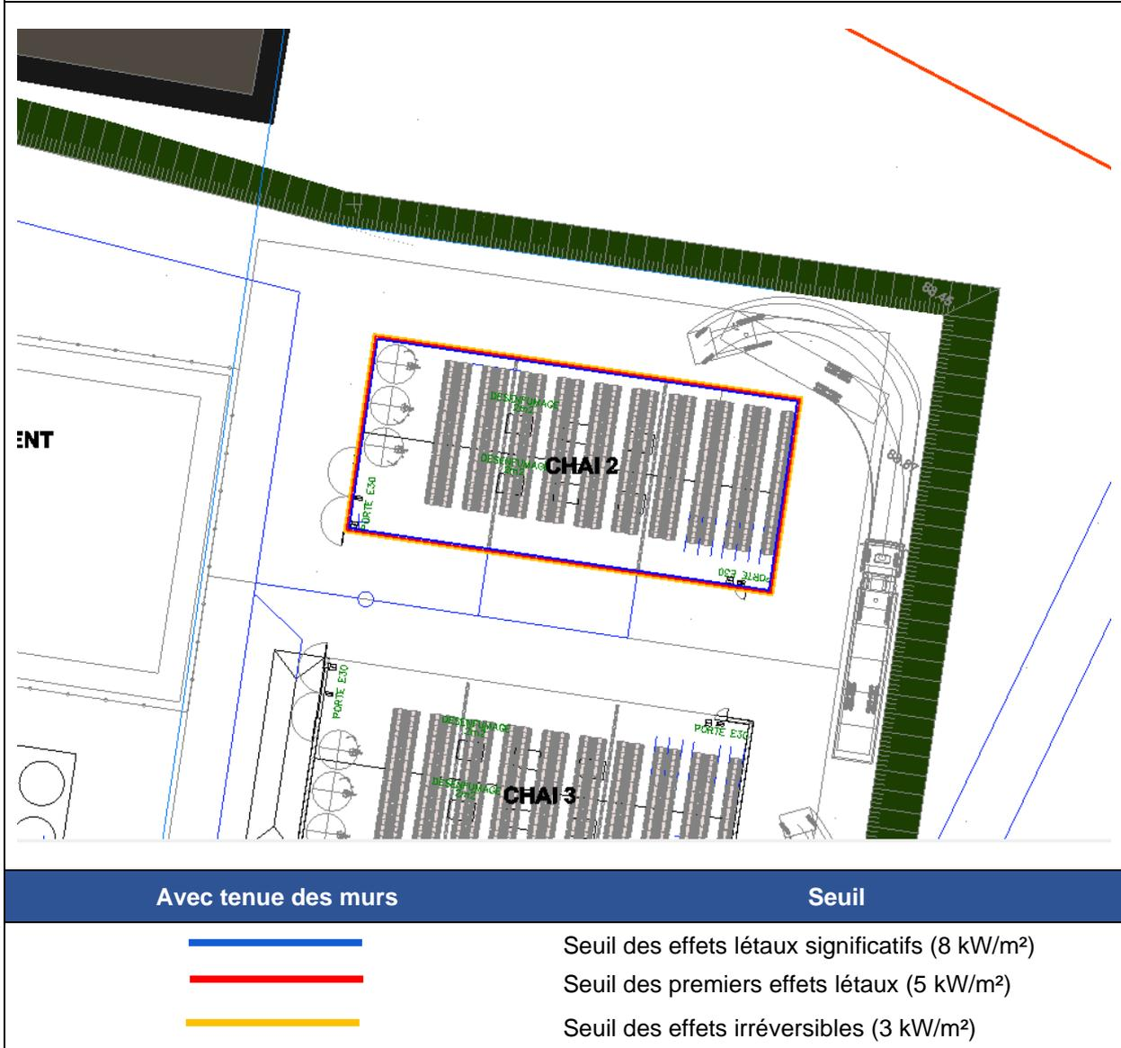
Toutes les cuves dans le chai disposeront d'une surface d'évent convenablement dimensionnée pour rendre le phénomène de pressurisation physiquement impossible. Avec tenue des murs, il n'y a pas d'effets à attendre à l'extérieur du chai.
